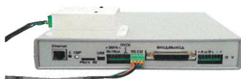
Рисунок А.2.2– Блок управления универсальный П-166Ц БУУ-02 с акустическим анализатором
